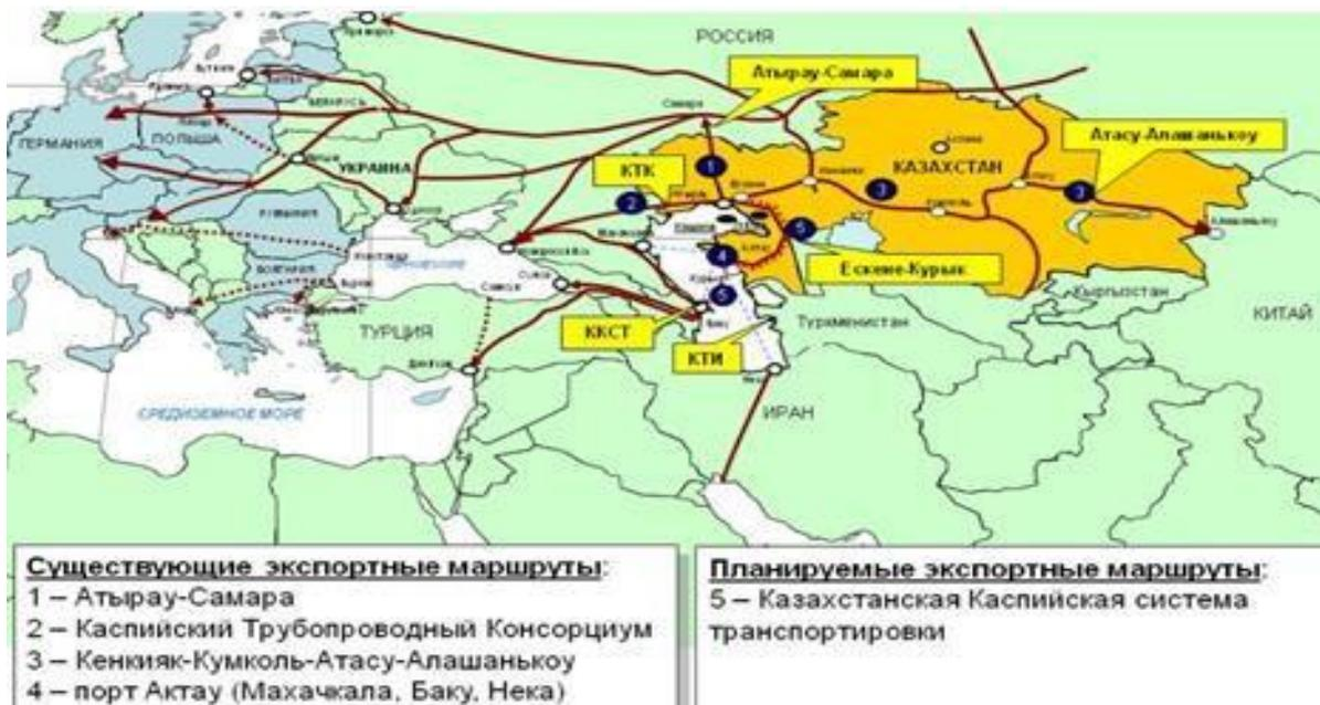
**Рисунок 1. Нефтепроводная система Казахстана**
