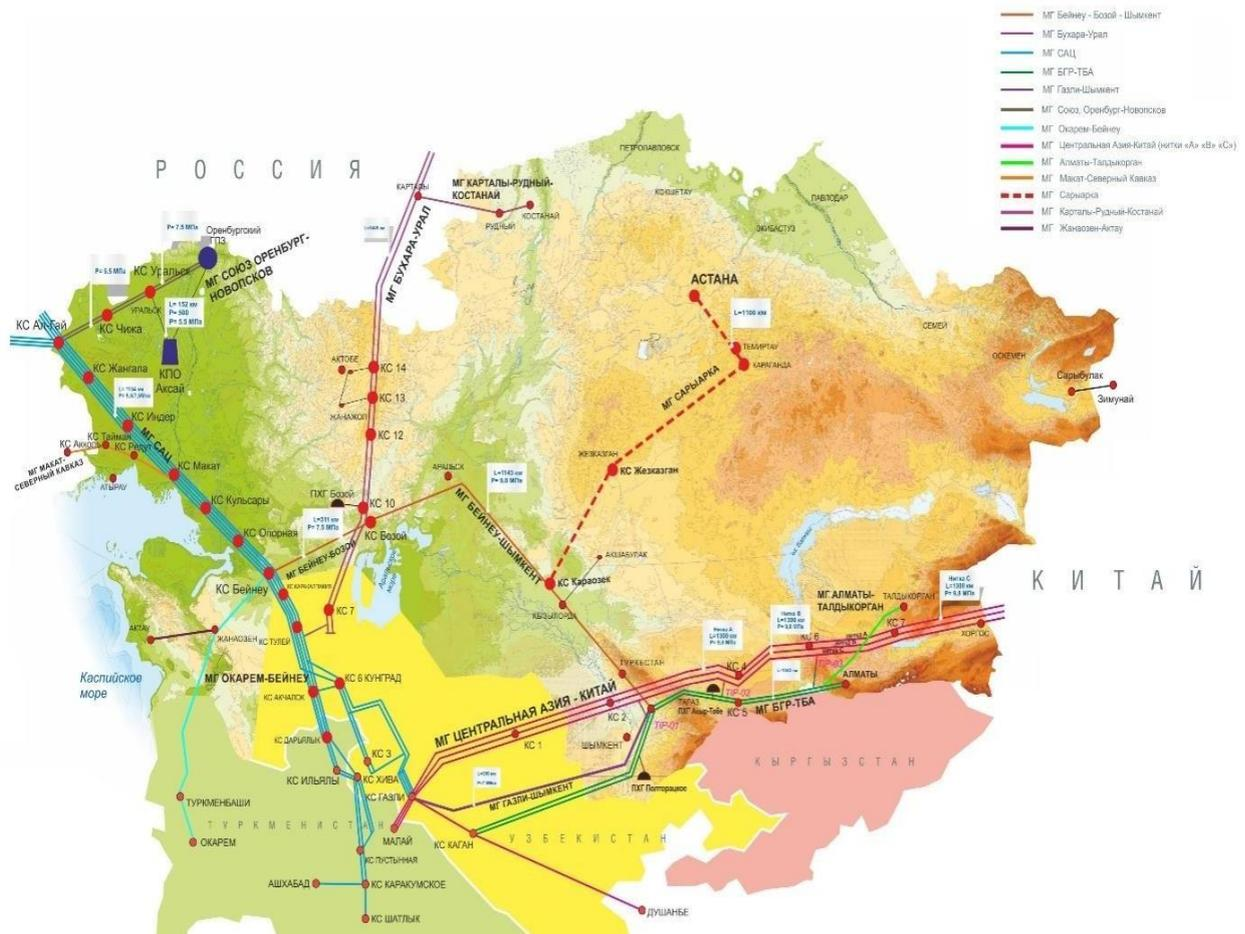
Рисунок 3. Схема магистральных газопроводов Казахстана
